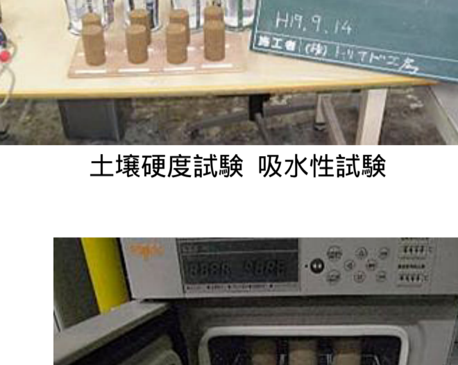
1軸圧縮強度試験
